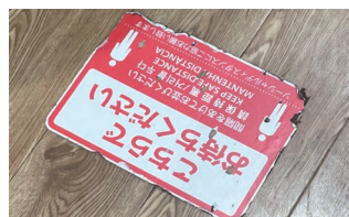
▲ 剥がれ部分に汚れ溜まり
